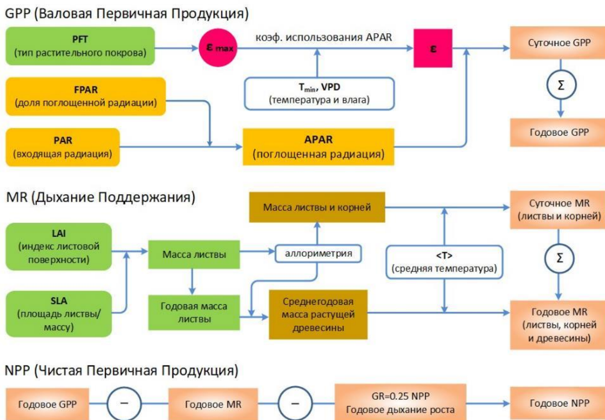
Рисунок 2.3.1.1 — Схема расчёта валовой и чистой первичной продукции (GPP/NPP) на основе алгоритма MOD17. Алгоритм включает три этапа: (1) расчёт валовой первичной продукции (GPP), (2) расчёт затрат на дыхание и поддержание роста (MR), которые этапе (3) суммируются для оценки чистой первичной продукции (NPP)
