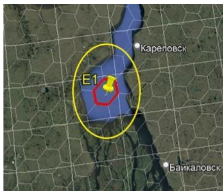
Рисунок 3.2.1.2 — Южная часть Енисейского залива. Пиксель радиометра MIRAS (жёлтый эллипс) с центральной ячейкой Е1 (красный шестиугольник)
