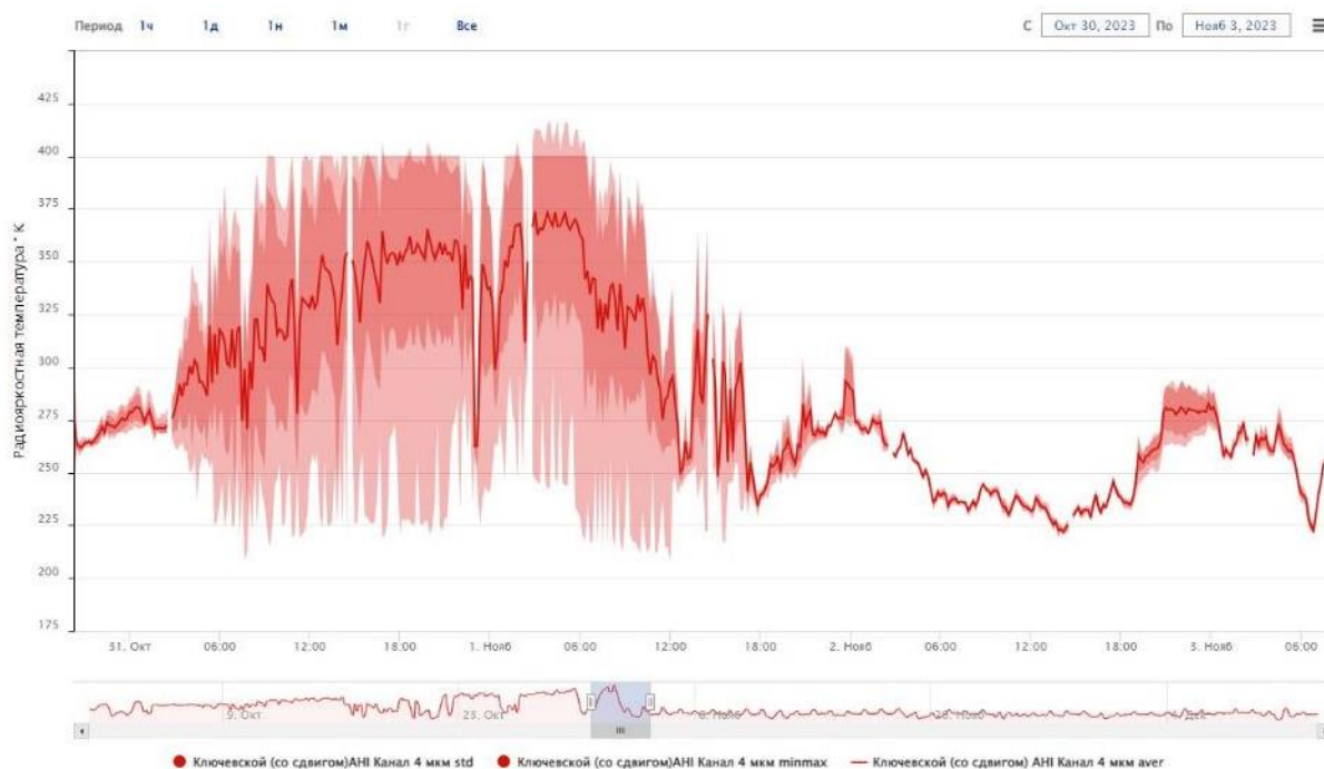
Рисунок 1.1.2.3 — Динамика радиояркосной температуры по данным АНІ на вулкане Ключевской с отображением среднего, стандартного отклонения и минимума/максимума в пределах участка наблюдения
