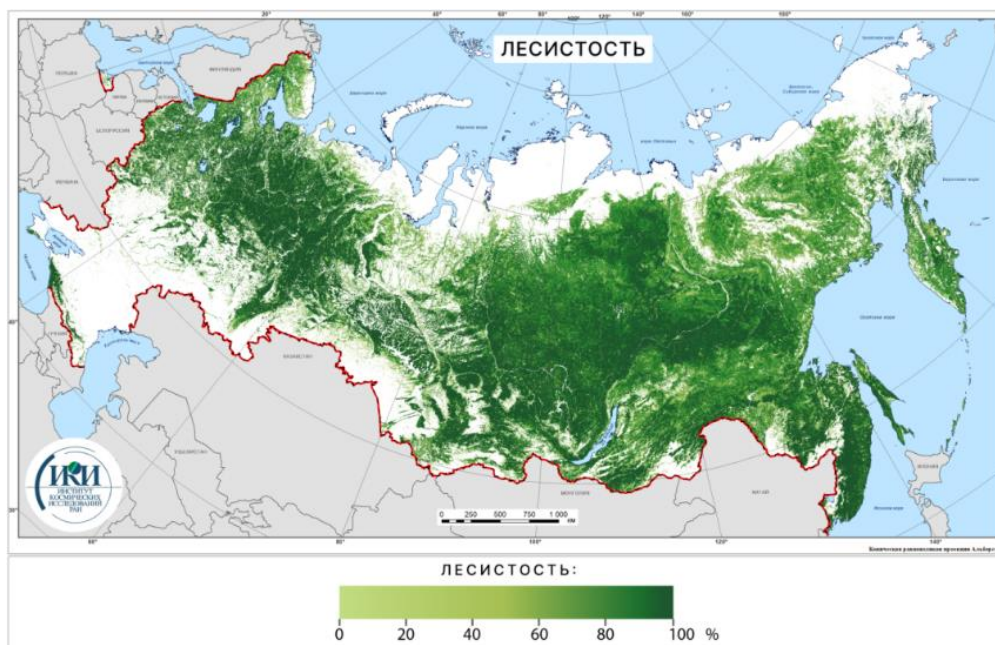
Рисунок 2.4.2.1 — Пример построенной по данным MODIS карты лесистости
