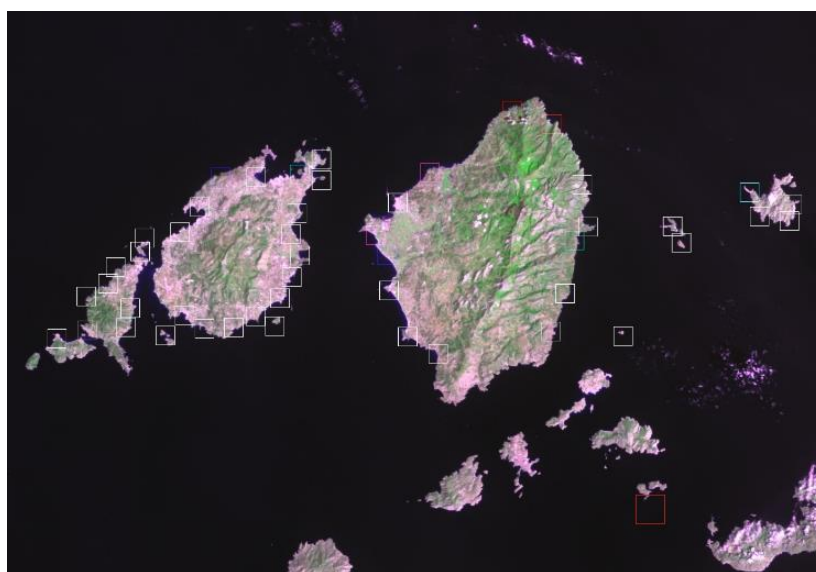
Рисунок 6.1.1.2 — Фрагмент изображения, полученного камерой МСУ-232 над островами в Эгейском море. Квадратами обозначены распознанные контрольные точки
