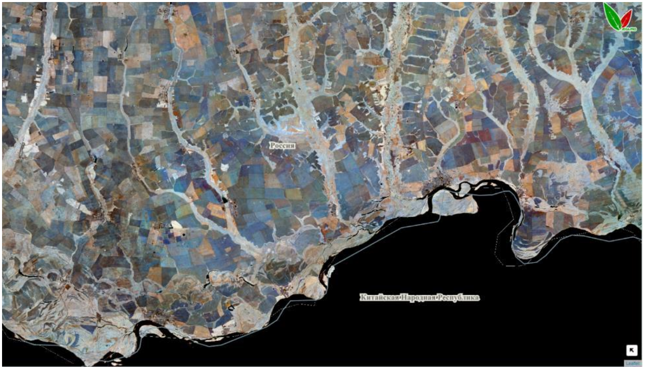
Рисунок 1.2.2.2 — Разновременной синтез месячных композитных изображений NDVI (RGB: май – июнь – июль) за 1986 г. на территорию юга Амурской области в интерфейсе системы Вега
