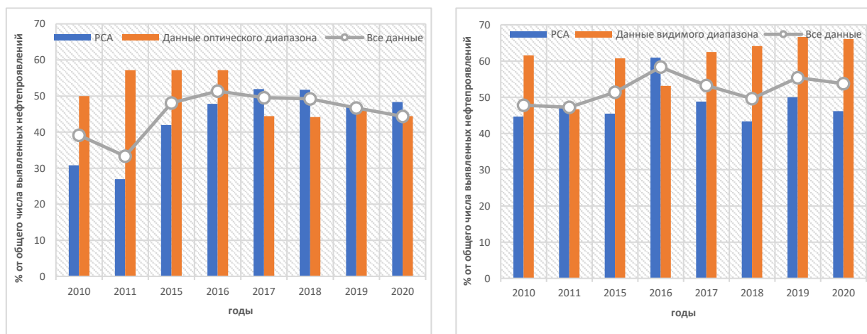
Рисунок 4.2.4.3 — Межгодовая изменчивость коэффициента выявляемости нефтепроявлений на морской поверхности, в районе м. Сефид Руд (слева) и п-ва Челекен (справа)
