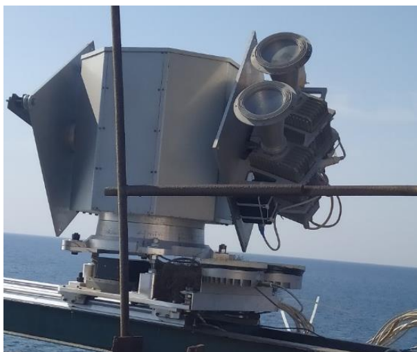
Рисунок 4.1.1.1 — Поворотная платформа «Траверс-2» с комплексом из двух радиометров 8-мм диапазона и веб-камера. Внизу видны калибровочные нагрузки
