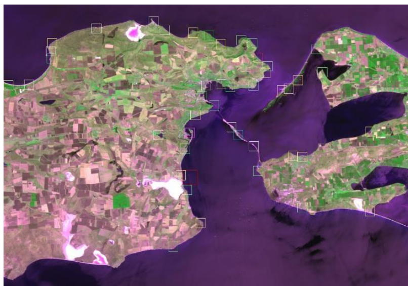
Рисунок 6.1.1.1 — Фрагмент изображения, полученного камерой МСУ-231 в районе Керченского пролива. Квадратами обозначены распознанные контрольные точки
