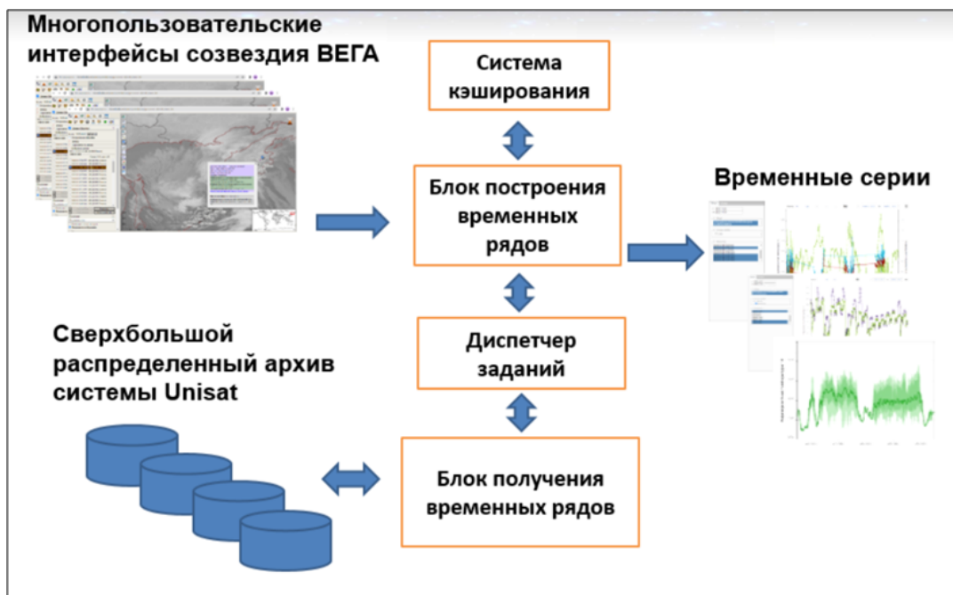
Рисунок 3.3.1.1 - Схема взаимодействия сервисов, задействованных при построении графиков временных рядов
