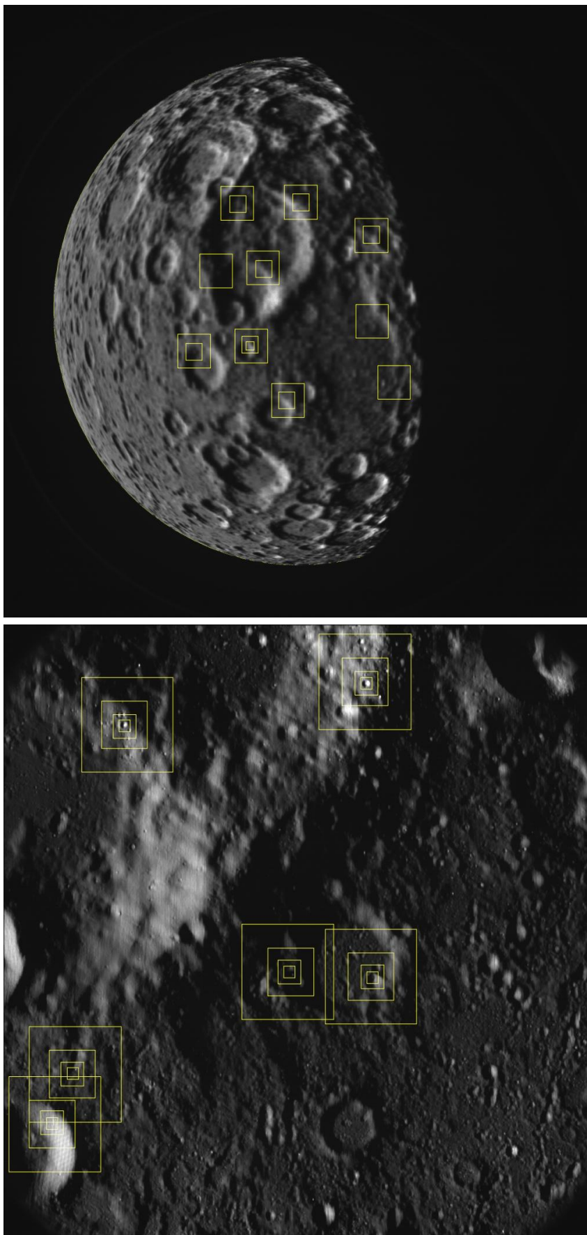
Рисунок 3.1 - Пример полученных на стенде изображений ШНК (вверху) и УНК (внизу) с высоты 200 км; желтым отмечены выделенные точки горизонта на изображении ШНК и контрольные точки на изображениях ШНК и УНК
