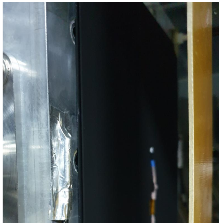
Рисунок 6.31 – Вид черненых пластины излучателя и пластины, наклеенной на термостол. В центре излучателя наклеен термодатчик
