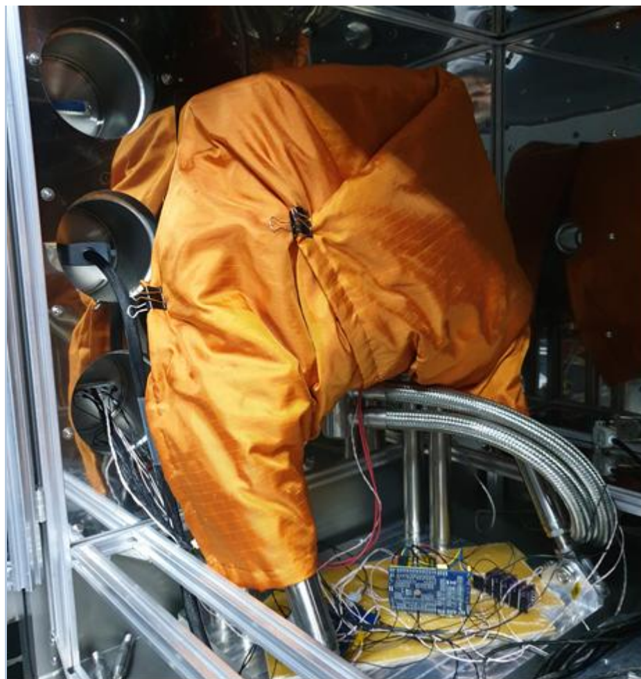
Рисунок 6.34 – Монтаж второго мата ЭВТИ и окончательный вид измерительного объема экспериментальной установки
