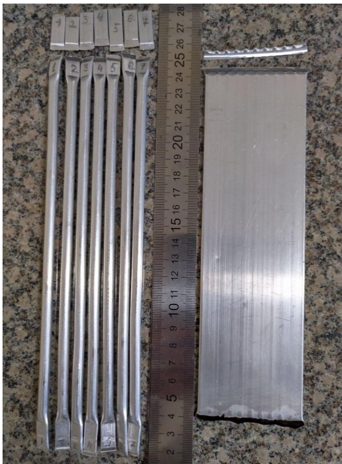
Рисунок 6.22 – Внешний вид заправленных и загерметизированных трубок, АМКП и отделённых хвостовиков
