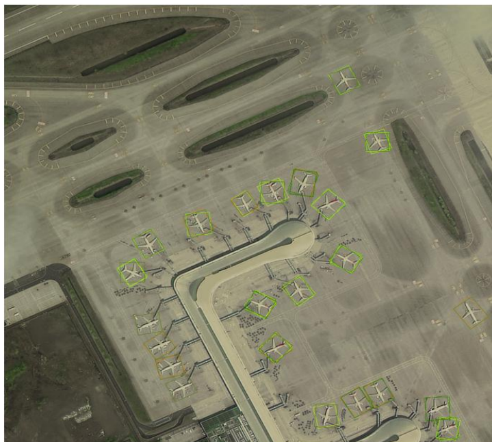
Рисунок 2.18 - Результаты детекции объектов на аэрофотоснимке с использованием сети ROI Trasformer (Ding et al.)
