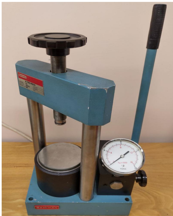
Рисунок 6.20 – Внешний вид гидравлического пресса для обжима трубок и АМКП (для наглядности верхняя платформа и защитный экран пресса удалены)
