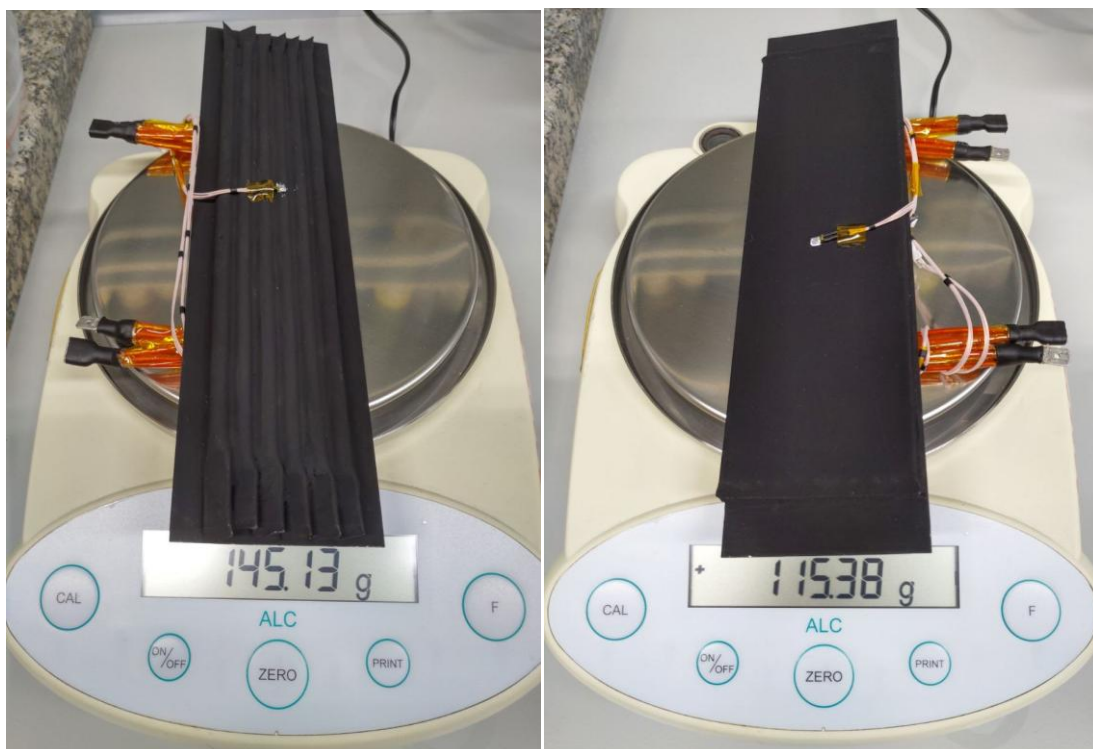
Рисунок 6.51 – Внешний вид опытных образцов тепловых аккумуляторов после проведения экспериментов в ТВК и результаты их контрольного взвешивания
