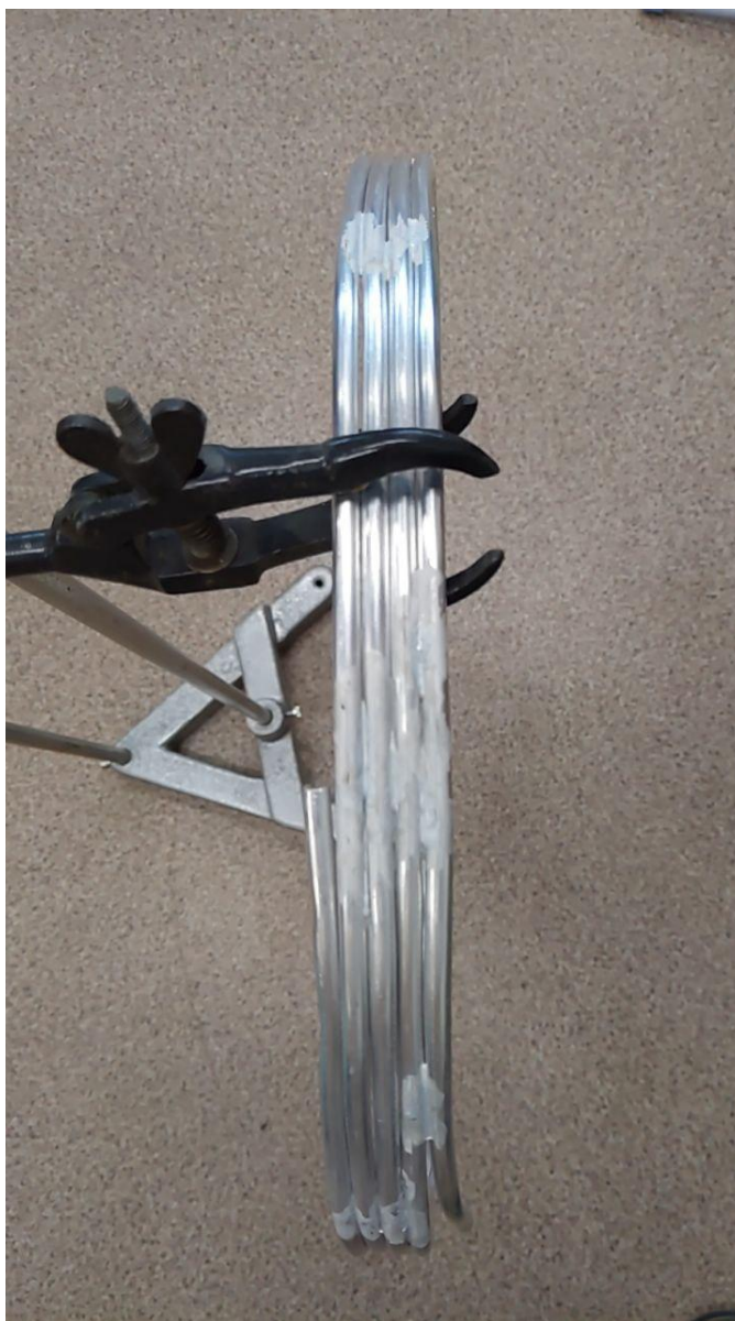
Рисунок 6.27 – Внешний вид катушки диаметром 40 см из трубки 6,35×1,0 мм после пайки витков друг к другу (в восьми точках)
