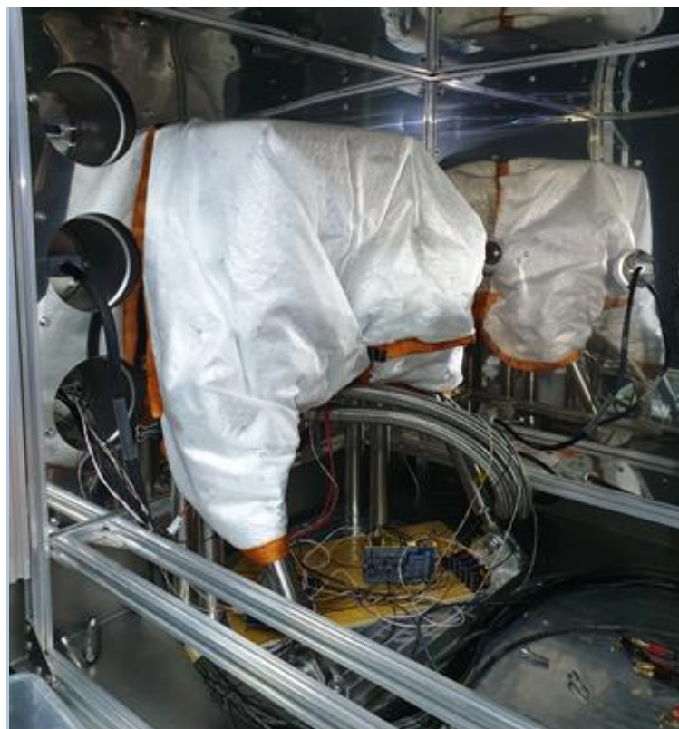
Рисунок 6.33– Вид измерительного объема, обернутого первым матом ЭВТИ
