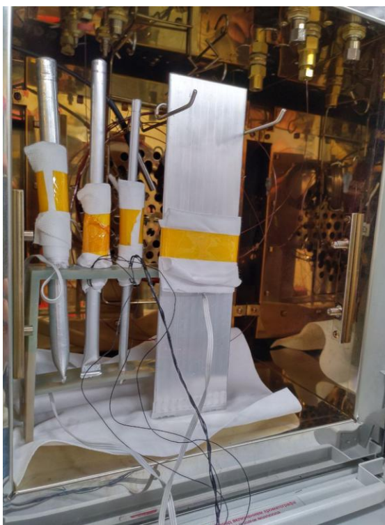
Рисунок 6.14 – Термостат с размещёнными в нём образцами и термодатчиками
