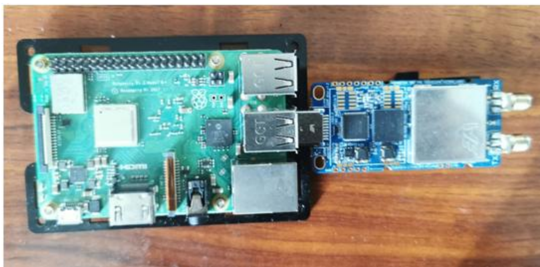
Рисунок 5.9 – Соединение Raspberry PI и LimeSDR-mini для проведения проверки радиоканала
