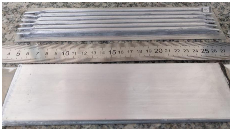
Рисунок 6.23 – Внешний вид трубок и АМКП, наклеенных на пластины из АМг6
