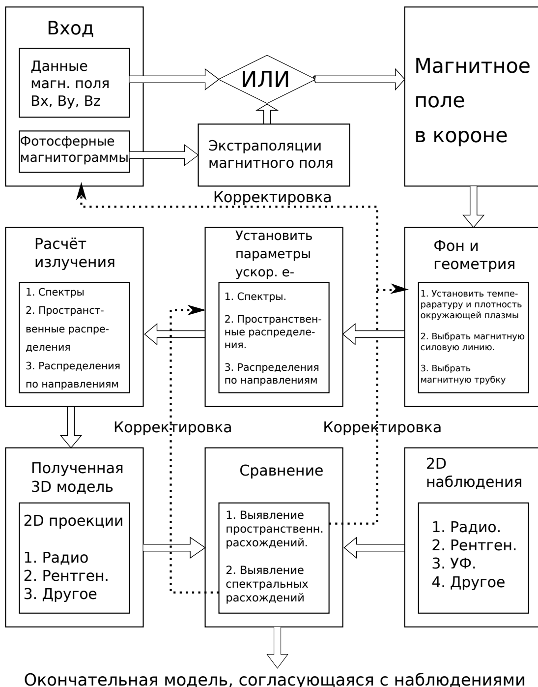
Рисунок 1.2: Блок-схема, иллюстрирующая принцип работы GX Simulator. Схема адаптирована из [92].
