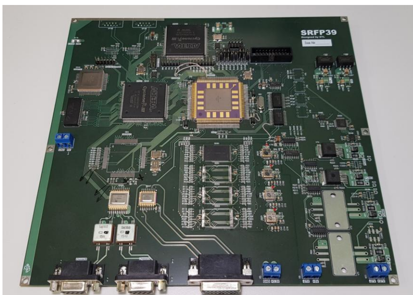
Рисунок 4.1 — Отладочная плата для ПЛИС Cyclone III.
